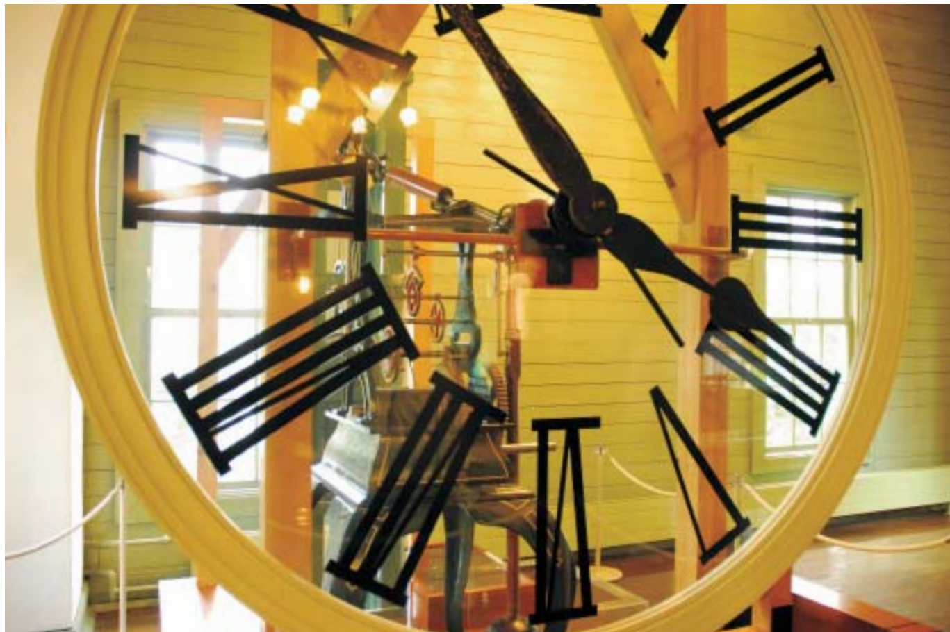
2階に展示されている実寸大の文字盤。直径は1m67cm。後ろに見えるのが時計機械で、その仕掛けを間近に見ることができる。これもハワード社製である。
