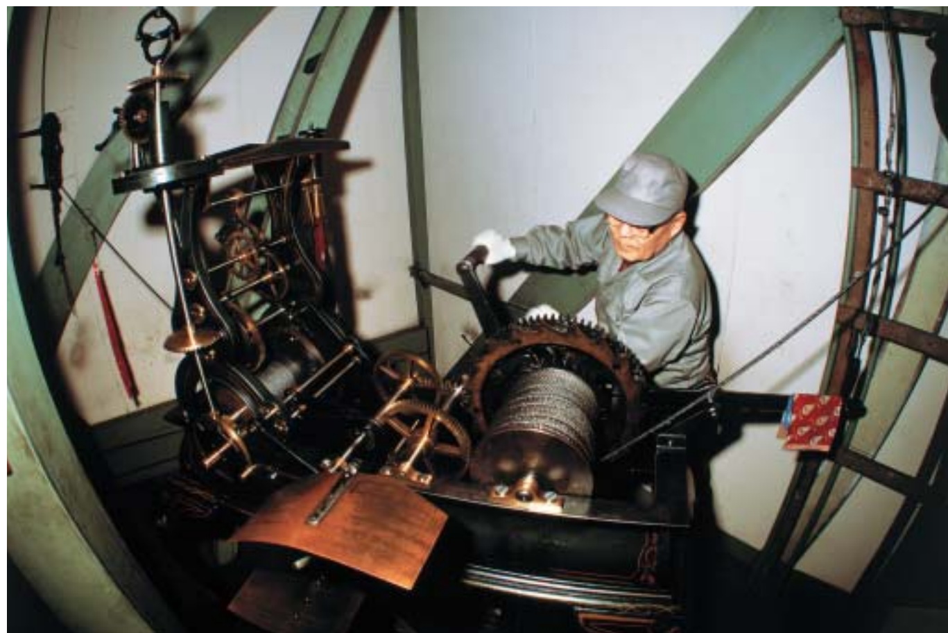
打鐘用のおもりをハンドルを使って巻き上げる井上清さん(1990年当時)。円筒に巻かれたワイヤーにおもりが吊り下げられている。左にあるのが針を動かす運針機械。(写真/札幌市)
