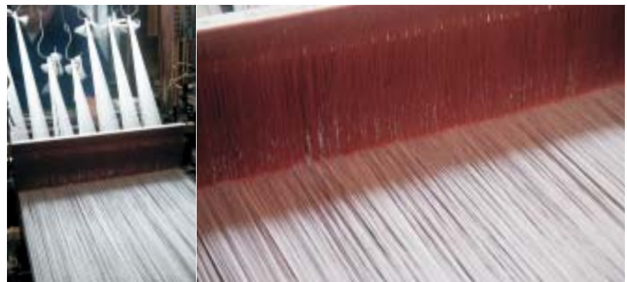
木染め、泥染め前のガス糸を使った拵。筵を織るともいう。他の産地は手づくりや板筵だが、本場奄美大島紬では拵機を用いる。図案に合わせて経糸で絹糸を強く締めなければならないため、男性の作業だ。
