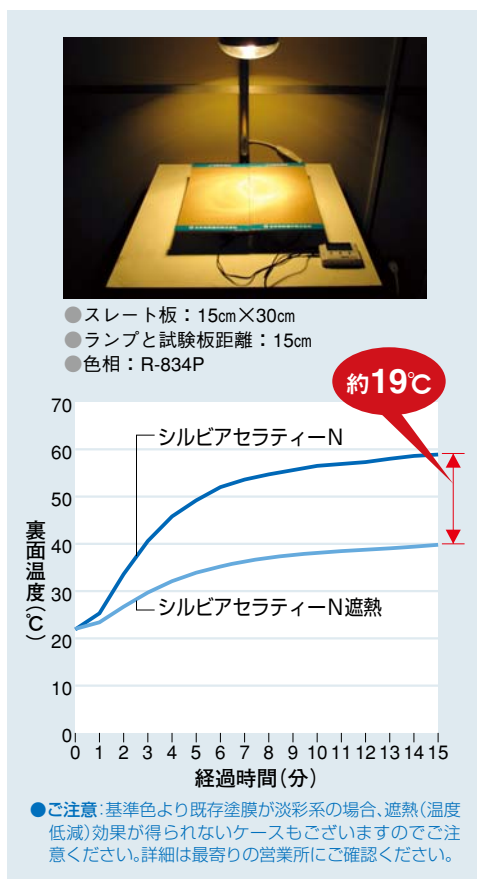
■図①／シルビアセラティーNと同遮熱を比較した遮熱性試験
