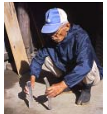
ひび割れした炭と良質の炭を下に落とし、その響きを比較する父親の勝さん
