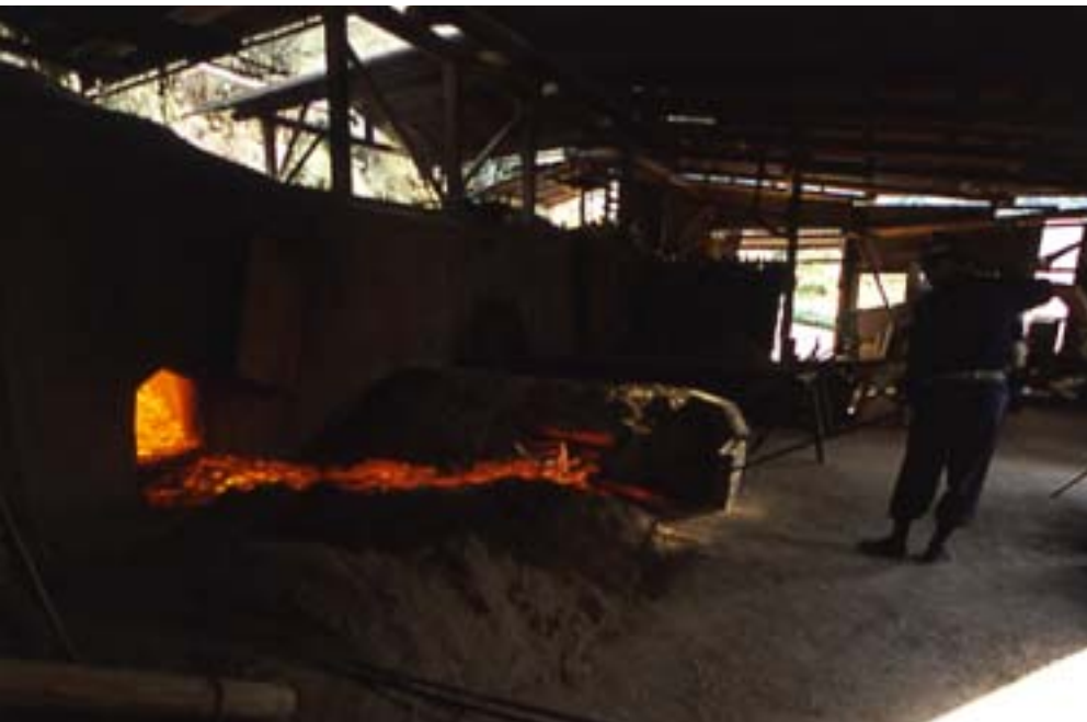
真っ赤に燃える炭を窯から出す道夫さん。原木を焼く備長窯に用いられる赤土も石も、紀州独特の耐火性のあるもの。備長炭は、まさに紀州の風土から生まれるものである
