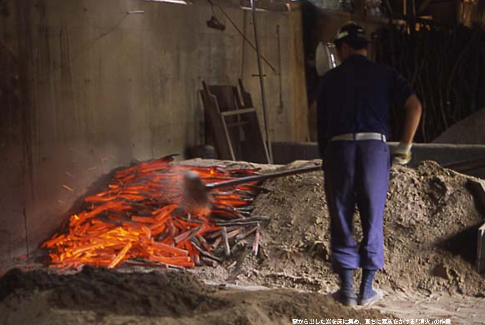
窯から出した炭を床に集め、直ちに素灰をかける「消火」の作業
