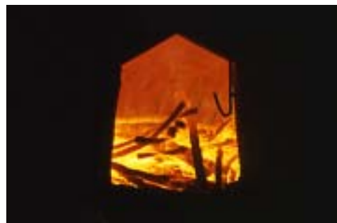
窯のなかの温度は、最高1300~1500度まで上昇する。高温で精煉されることで、炭は硬く、良質なものになる
