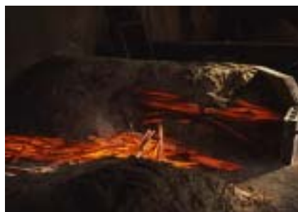
窯から取り出した木炭を冷ますための“消し粉”には、木の灰が用いられている。窯によっては、独自に赤土を混ぜるなどの工夫も行なっている
