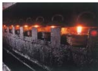
炎の先が軽く上皿に触れている状態が、煤がもっとも効率よく採れる。
