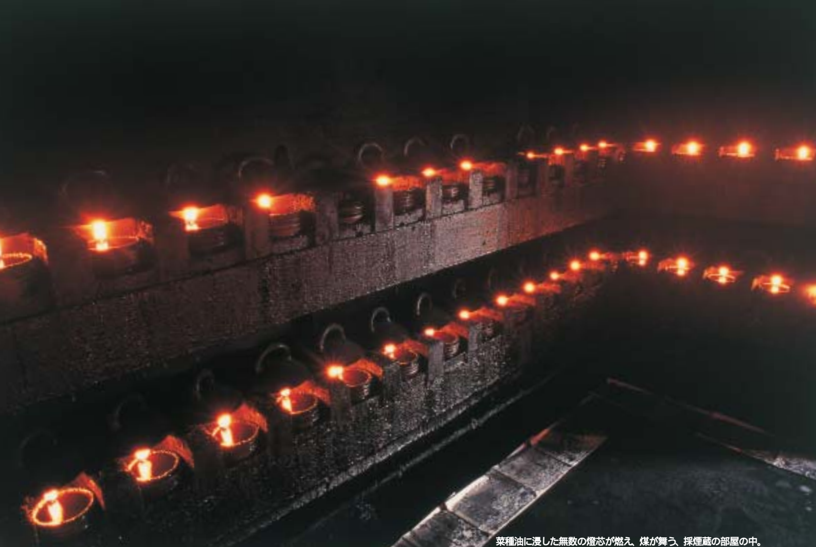
菜種油に浸した無数の燈芯が燃え、煤が舞う、採煙蔵の部屋の中。
