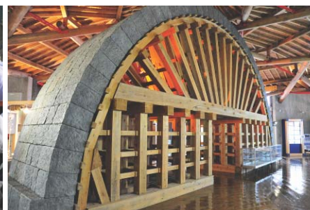
▲社会科見学のために来館した小学生にアーチの構築法と原理を説明する上塚館長(左上)。支保工の模型に沿って輪石(アーチ石)を並べた後、支保工をはずしても輪石が崩れない。石匠館には、巨大な支保工の模型(右上)、サイホンや滑車といった実験器具などもあり、石橋工法がわかりやすく展示されている。なお、建物は石橋の材料の凝灰岩を積み上げたもの(下)。東隣りには石工・橋本勘五郎の生家がある。石橋資料館「石匠館」／八代市東陽町北98-2 ● ☎ 0965(65)2700 ● 9時~16時30分(入館は16時まで) ● 月休(祝日の場合は翌日休)、12月29日~1月3日休
