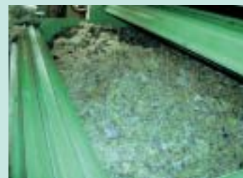
東九州工場の防音材リサイクルライン
