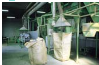
静岡工場の防音材リサイクルライン
