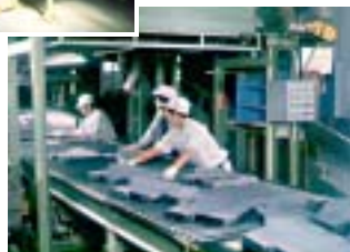
平塚工場の自動車用制振材生産ライン
