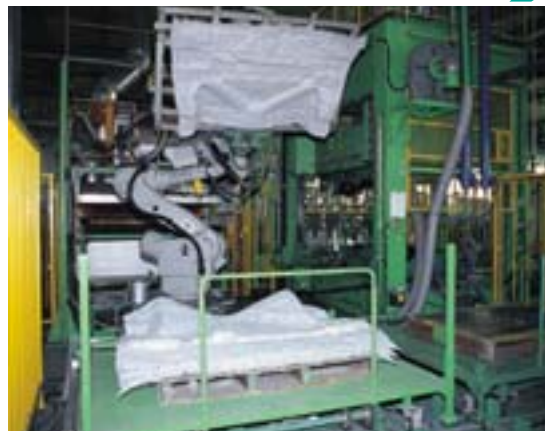
リサイクル繊維を利用した防音材の製造（東九州工場・静岡工場）
