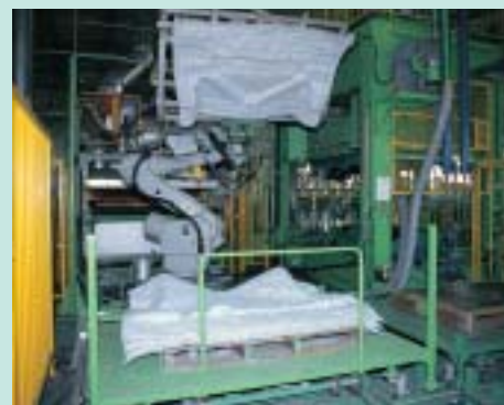
リサイクル繊維を利用した防音材の製造 (東九州工場・静岡工場)
