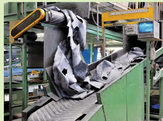
▲平塚工場の制振材リサイクルライン
