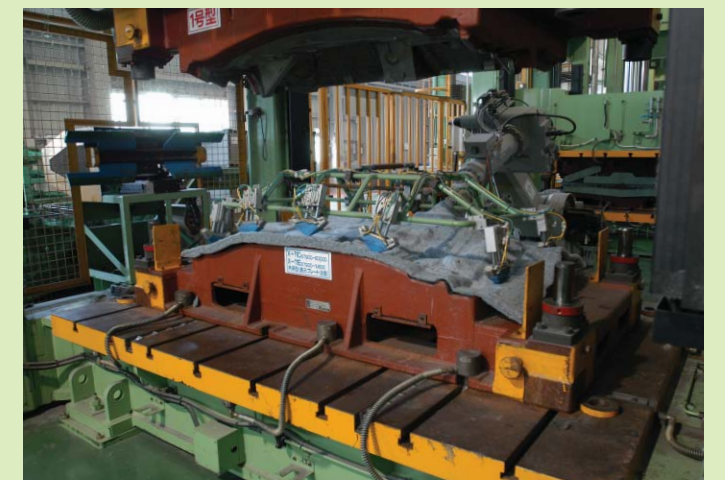
▲リサイクル繊維を利用した防音材の製造 (静岡工場・愛知工場・東九州工場)
