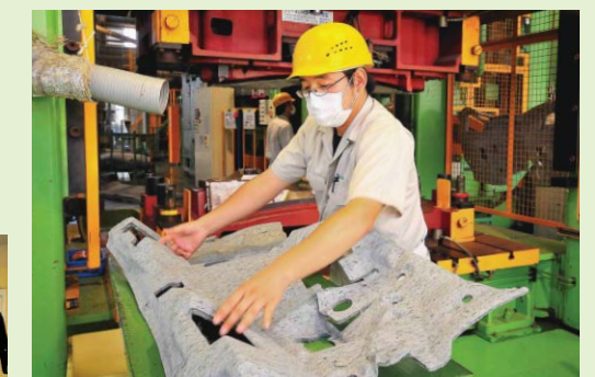
▲静岡工場生産されているユニフォームを使用した自動車用吸・遮音材
