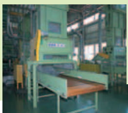
▲平塚工場の制振材リサイクルライン
