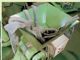
▲静岡工場の防音材リサイクルライン
