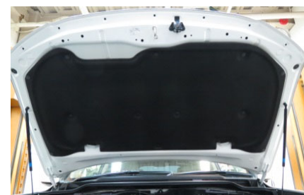
自動車用吸音材「フードインシュレーター」
