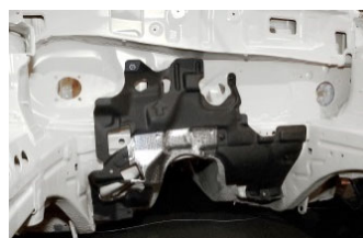
自動車用吸・遮音材 「ダッシュアウターインシュレーター」
