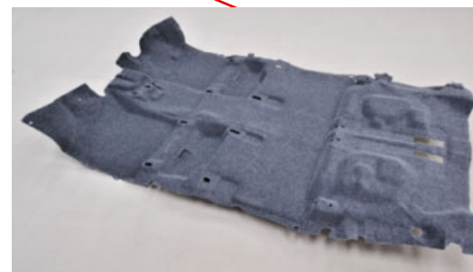
自動車用吸・遮音材「フロアカーペット」
