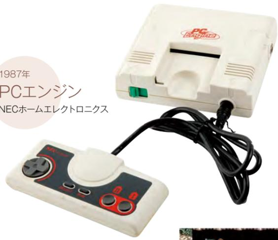
ファミコンを凌ぐグラフィックとサウンドで一時代を築いた最後の8ビット機。ゲームソフトにはHuカードと呼ばれるICカード型のROMが採用され、のちに世界初のCD-ROMによるソフトも供給。PCメーカーらしく、本体のバリエーションが多い。
