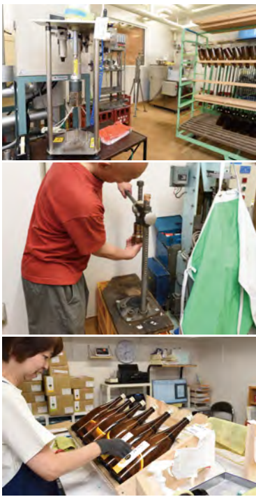
上：瓶詰や火入れ（加熱殺菌）を行う場所。左手前は今年新たに導入した瓶に蓋をする機械。中：岐阜から持ってきた一升瓶に蓋をする機械。意外と手作業が多い。下：瓶詰め後のラベル貼り。瓶の下から光を当て、異物が入っていないかなども確認。
