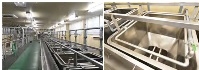
浸漬(吸水)の工程。洗った米は水でここまで運ばれ、分離機にかけて米は四角いタンクに、とぎ汁は手前の樋から流れる。タンクに水を張り、米が必要量を吸水したら余分な水を抜く。水を吸った浸漬米はタンクの底から排出されてベルトコンベアで蒸す工程へと進む。
