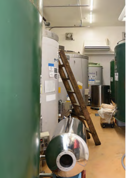
岐阜から運んだ貯蔵タンク。緑のタンクは山田さんが生まれた頃から使われていたそうで、冷却機能はない。グレーのタンクは温度調節が可能。
