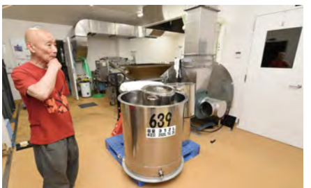
種麹の胞子を振り掛けて3日経った米をこの小さなタンクに移し、甃を造る。
