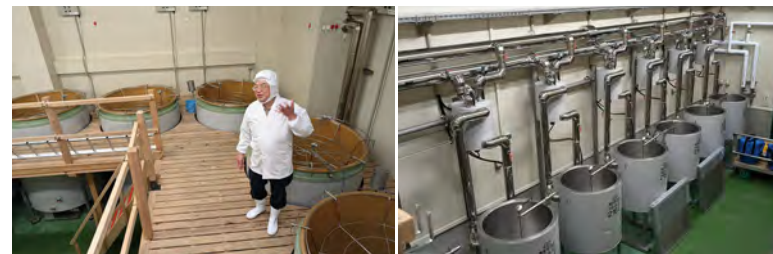
純米大吟醸の仕込み蔵。左は高さ1.8mの仕込みタンク。レギュラー酒に比べ少量の3,000ℓ、総米2トンを手間をかけて仕込む。右は純米大吟醸の酒母タンク。
