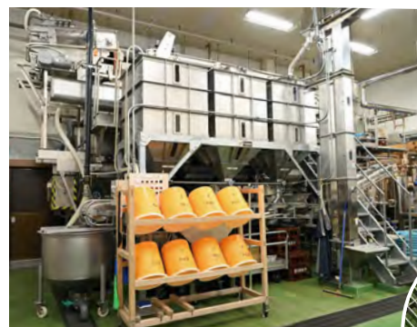
左の写真は洗米機。精白して冷ました米は異物選別機にかけた後、水で洗う。下は衛生管理が徹底された洗い場の床。水硬性ウレタンの床は丁寧にブラシがけし、排水溝のフタも取り外して洗う。
