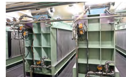
濾過板と压榨空気で膨らむシートが互い違いに重なっている搾り機。発酵を終えた醗を入れて圧を加えると、酒だけが外にこぼれ出る。中に残ったものが酒粕である。
