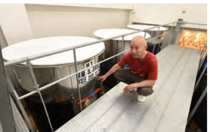
仕込み用のタンク。仕込みの米の数量は最大1トン。製造工程はショップからガラス越しに見ることができる。
