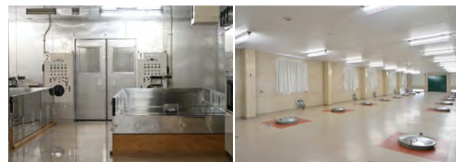
左は2階製麹室。3階で麹菌の胞子を散布した蒸米をここに降ろし、6基の培養槽で麹に仕上げる。蒸米から麹になるまで二昼夜かかる。右はレギュラー酒仕込み室フロア。床下には深さ4.5mのタンクが並ぶ。タンク1基で一升瓶1万本強の酒ができる。
