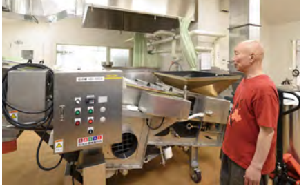
洗米機、蒸し器、放冷機がコンパクトにまとまっている。岐阜よりも狭いが、醸造量はいまの方が多という。
