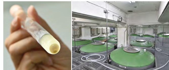
左：マイナス75℃で保管されている自社保存の7号酵母。底の黄色いビーズの周りに見えるのが酵母菌で、酒の香りや味わいを紡ぎ出す。右：超硬水を使う「風の森」は、発酵力を抑制するために冷却能力に優れた仕込みタンクを使用。
