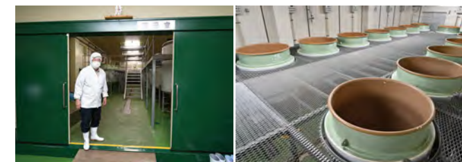
酵母を育てる酒母室。造る酒と同じ麹と蒸米、水を使って、奥に並ぶ小さなタンクで拡大純粋培養を行う。できた酵母はスターターとして別室の大きな仕込みタンクに移し、そこに麹、蒸米、水を3回に分けて入れる。4日間かけて三段仕込みを完成させる。
