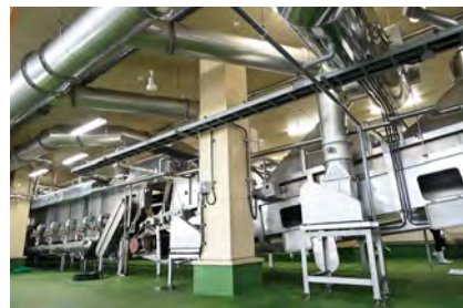
ベルトコンベアで運ばれてきた浸漬米は、写真奥の連続蒸米機で最初は弱火、最後は高圧蒸気で約45分かけてカラッと蒸し上げる。蒸された米は手前の連続放冷機に運ばれ、温風、外気、冷風と順番に当てて徐々に冷ます。頭上の太い管に冷水が通っていて、その冷風が放冷機の米を冷まし、熱い蒸気は下から排出される仕組み。
