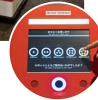
ポーターロボットが荷物を載せて部屋まで案内してくれる。到着して荷物を降ろした後、タッチパネルで働きぶりを評価する。
