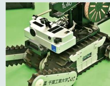
搭載しているカメラは、機体の前後と、上からロボット全体を見渡すアウロビューなど計4つ。ほかに通信ケーブルやセンサー、計器類、LED照明などを搭載して移動できる最小サイズが、この「櫻丸」。幅42×高さ80×長さ53~107cm、重量35kg。連続稼働時間は8時間。
