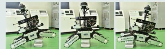
「櫻丸」は45度傾いても倒れない設計。クローラーが階段2つにまたがれば坂道を登ると同じ状況になる。完全防水なので水中でも作業できるが、原発の汚染水はできるだけ接触面を減らすため、立ち上がった状態で移動する。「櫻丸」はイギリスの水路調査など、海外でも活躍。
