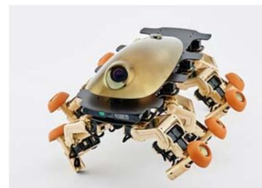
環境と共存できる乗り物をコンセプトに、2007年に開発された「ハルクII」。56個のモーターを装備し、車輪走行と脚歩行が可能。全長80.5cm、重量20kg。
