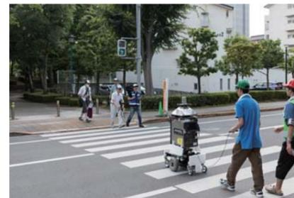
「つくばチャレンジ2017」の7月の実験走行では、ロボットが2kmの公道を自律走行。さらに、信号を判断して横断歩道を渡りながら対象人物を探す「人探し」の課題のクリアを目指した。
