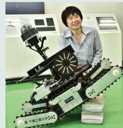
千葉工業大学未来ロボット技術研究センターの研究員・西村健志さんと、災害対応ロボットの「櫻丸」。2011年の原発事故の際、「クインス」改良に不眠不休で取り組んだという。災害対応ロボットは「専門知識のない人が扱っても壊れない設計や、操縦しやすいインターフェイスが大切」と語る。
