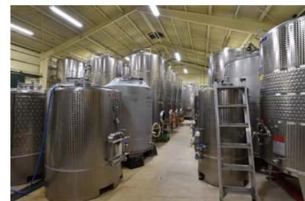
2~10klまで大小さまざまなステンレスタンクで発酵させる。シュール・リー醸造法や樽発酵など作り方のバリエーションが増えたため、それに合わせたタンクの種類も多くなった。胴の中央部に水を通して温度調整しているタンクもある。
