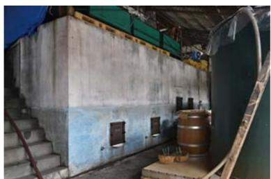
白と青に塗り分けられたコンクリートタンクは赤ワインの発酵タンク。収穫したブドウは梗を取り除き、皮に傷をつけて種ごと発酵させるが、発酵中の炭酸ガスで果皮や果肉が押し上げられ、液に浸かっていないと色素やタンニンが抽出できないため、1日2回、丸い小さな呑み口から液を抜き、ポンプで循環させる。これをルモンタージュという。
