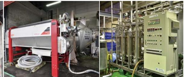
左：圧搾機の説明をしてくれる企画部の坂本泰隆さん。圧搾機の中に風船が入っていて、空気を送り込んで風圧でブドウを押し付けて絞る。一度に6トン（6,000本）のワインを搾ることができる。中：2017年に導入した最新式圧搾機。窒素置換でブドウが酸化することがなく、特にソーヴィニヨン・ブランは香りがよくなったという。右：精密ろ過器。0.2ミクロンと非常に細かい目で、酵母を通さない。瓶に酵母が入ると再発酵する危険性があるため、ワインの種類によってはこのろ過機を使用。
