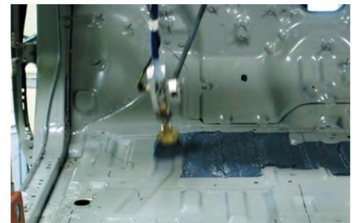
▲NTダンピングコート(塗布型制振材)
