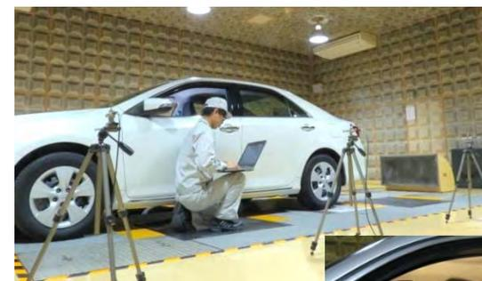
音響解析のための実車テストベンチ (スムーズ&ラフ面)
