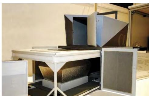
ISOCELL : 防音部品の音響透過損失測定装置
