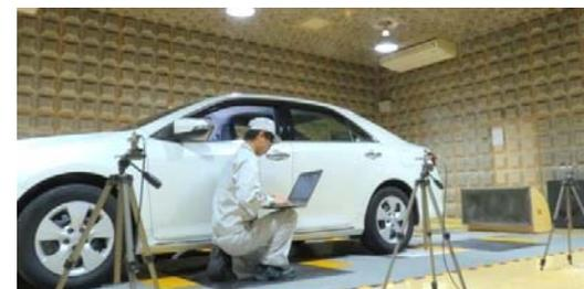
音響解析のための実車テストベンチ (スムーズ&ラフ面)
