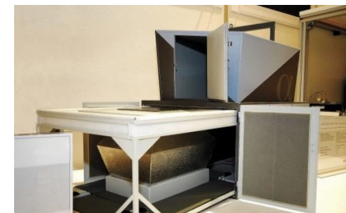
ISOCELL : 防音部品の音響透過 損失測定装置
