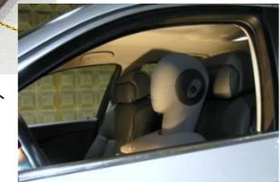
音響解析のための実車テスト ベンチ (スムーズ&ラフ面)
