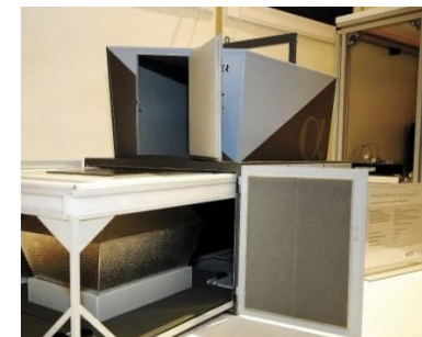
ISOCELL：防音部品の音響透過損失測定装置
